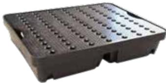
PE-Auffangwanne für wassergefährdende Flüssigkeiten und Kleingebinde bis 40 Liter. Mit PE-Gitterrost und allgemeiner bauaufsichtlicher Zulassung. DIBt-Zulassung Z-40.22-360. Maße (BxTxH): 800 x 600 x 155 mm. Auffangvolumen: 40 Liter. Belastung: 100 kg. Eigengewicht: 6,5 kg.
