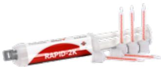
RAPID-2K ist ein Zwei-Komponentenkleber auf Cyanacrylatbasis, der ideal für Notfallreparaturen geeignet ist. Er besitzt hervorragende Klebeeigenschaften auf vielen unterschiedlichen Materialien wie z. B. Holz, Papier, Leder, Textilien und vielen Kunststoffen (bspw. PVC, ABS, PC, PBT). Durch die herausragenden Spaltfülleigenschaften (bis zu 6 mm) ist er bestens für Verklebungen geeignet, bei denen ein Klebespalt benötigt wird. Setinhalt: 1 x Doppelkartusche 10 g, 5 x Mischdüsen, 1 x Kolben.
