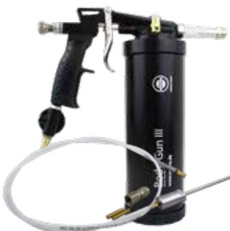
Die Hohlraum- und UBS-Spritzpistole für die professionelle Anwendung und den Einsatz von 1-Liter-Dosen. Robuste Bauweise für höchste Beanspruchung. Stufenloser Druckregler. Durch WB-Ventil auch für wasserbasierende Produkte geeignet. Mit Einstellmöglichkeiten für verschiedene Strukturen am Fahrzeug. Zusätzlich erhältlich: 3-teiliges Hohlraumsprüh-Set für die Verarbeitung von Hohlraumkonservierung:
