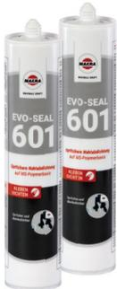
Auf MS-Polymerbasis. Gute Haftung auf vielen Metallen (Zink, Aluminium, Stahl), Lacken und Grundierungen, Holzwerkstoffen, Duro- und Thermoplasten (außer PE, PP, PTFE), Glas und mineralischen Untergründen. Mit den meisten handelsüblichen Reparaturlacken nass-in-nass oder erfahrungsgemäß bis zu zwei Stunden ohne Aktivierung der Oberfläche überlackierbar. Silikon- und isocyanatfrei. Problemlose Nachbildung der werksoriginalen Optik.
