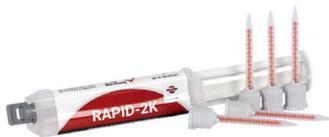
RAPID-2K ist ein Zwei-Komponentenkleber auf Cyanacrylatbasis, der ideal für Notfallreparaturen geeignet ist. Er besitzt hervorragende Klebeeigenschaften auf vielen unterschiedlichen Materialien wie z. B. Holz, Papier, Leder, Textilien und vielen Kunststoffen (bspw. PVC, ABS, PC, PBT). Durch die herausragenden Spaltfülleigenschaften (bis zu 6 mm) ist er bestens für Verklebungen geeignet, bei denen ein Klebspalt benötigt wird. Setinhalt: 1 x Doppelkartusche 10 g, 5 x Mischdüsen, 1 x Kolben.
